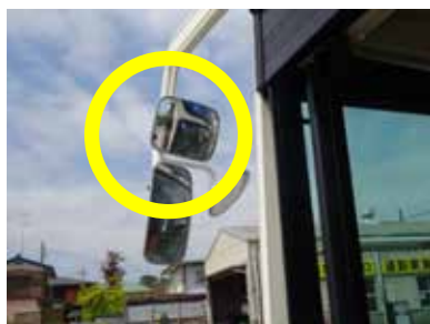
【車両左側方を広範囲で確認する為の補助ミラー】 【バックカメラ・モニター】
