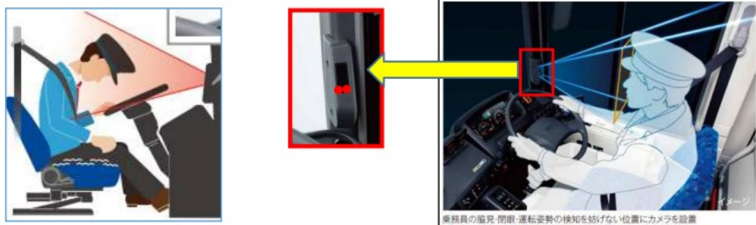
【ドライバーステータスモニターと連動して検知する自動検知式 EDSS の動作イメージ】
